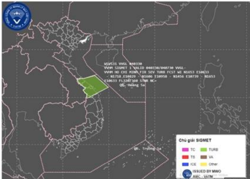
Bản tin SIGMET đề họa cảnh báo nhiễu động trong FIR Hồ Chí Minh - Một trong những sản phẩm dự báo/cảnh báo nhiễu động đối với hoạt động bay của Trung tâm Cảnh báo thời tiết - Trung tâm Khí tượng hàng không
