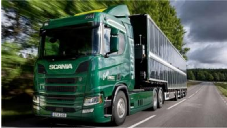
Xe tải 560 mã lực với toa móc dài 18 m, trong đó 100 m 2 được phủ những tấm pin mặt trời 13,2 kW
