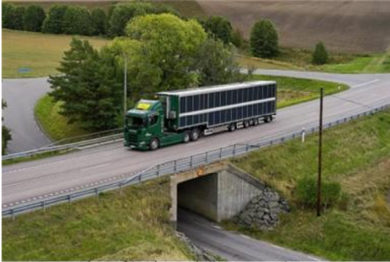
Xe tải 560 mã lực với toa moóc dài 18 m, trong đó 100 m 2 được phủ những tấm pin mặt trời 13,2 kW.
