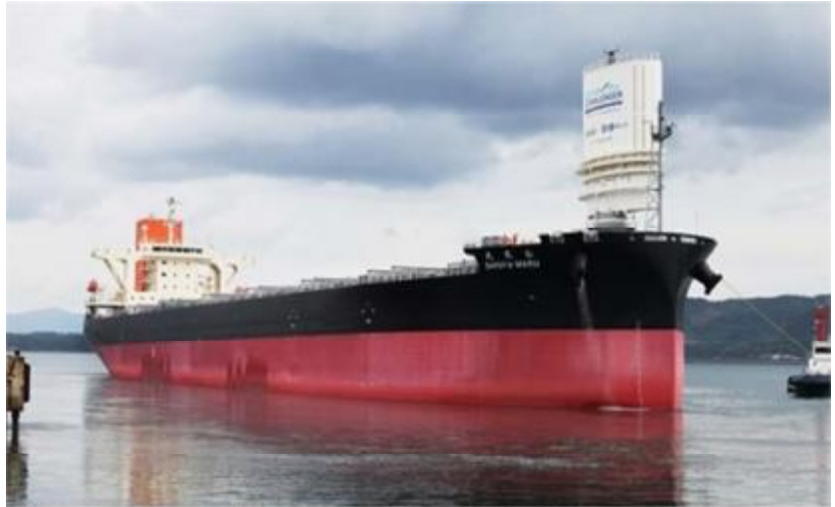
Việc lắp đặt công nghệ đẩy gió của Mitsui OSK Line trên tàu chở hàng sẽ làm lệch cân cân của công suất hàng hóa chạy bằng năng lượng gió lên đến trên một triệu DWT
