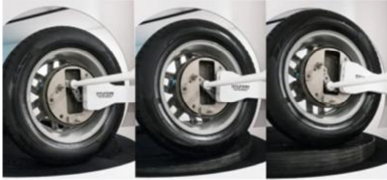
Mô tả hệ thống truyền động thu gọn vào mâm xe của Uni Wheel.
