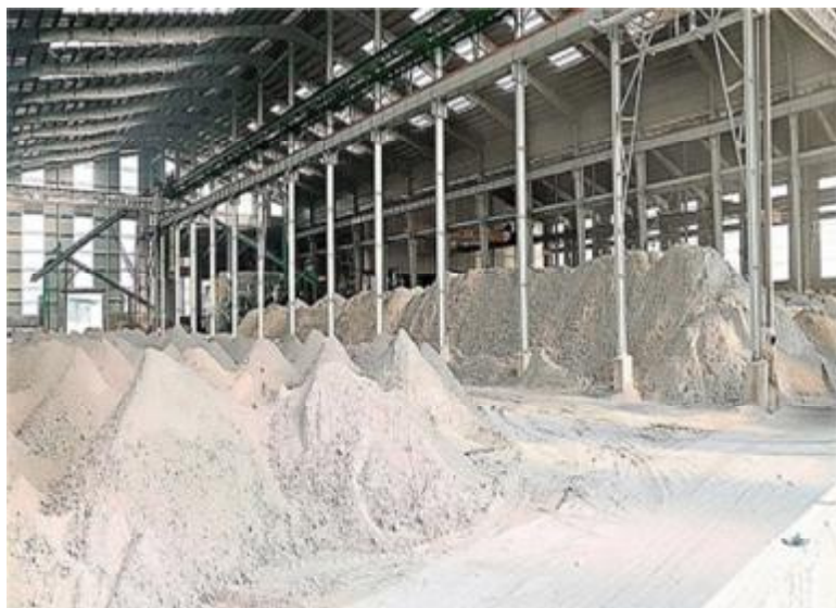
Bã thải thạch cao phospho có thể sử dụng làm lớp móng cho đường giao thông và làm vật liệu san lấp cho công trình xây dựng
