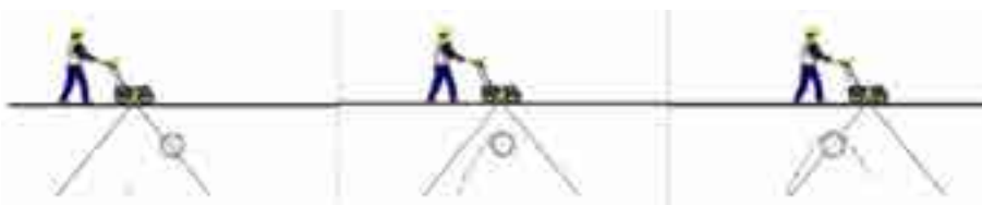
Hình 2.2. Quá trình dò đối tượng bằng thiết bị ra đa xuyên đất
