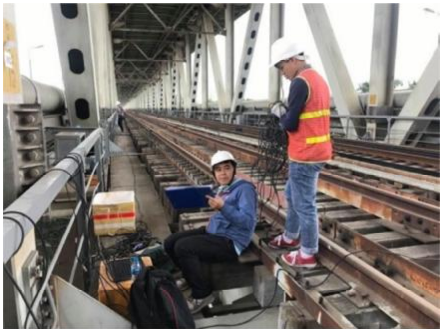
Đo hiện trường để xây dựng bản sao số cầu Thăng Long. Ảnh: Nhóm Nghiên cứu
