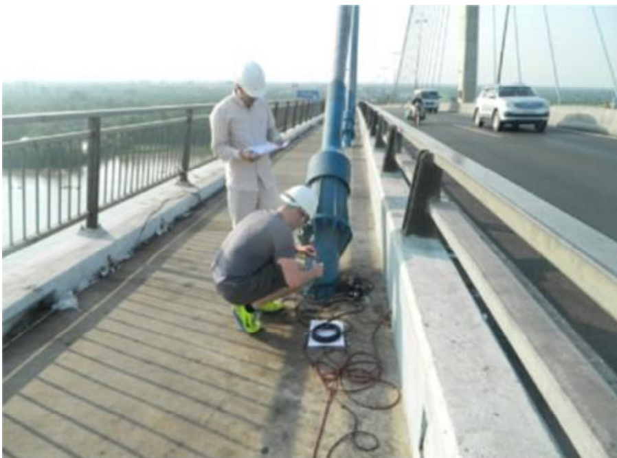
Lắp đặt các thiết bị đo dao động cầu Mỹ Thuận (Vĩnh Long). Ảnh: Nhóm N.cứu
