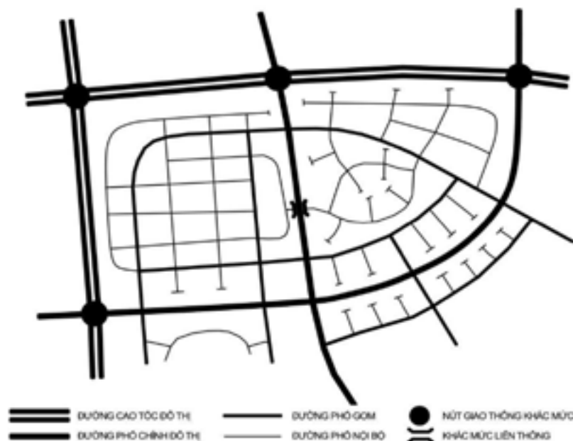
Hình 5. Sơ đồ nguyên tắc nối liên hệ mạng lưới đường theo chức năng [7]
